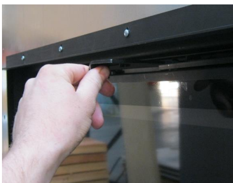
Position 1: Luckfönstret öppet Position 2: Luckfönstret stängt
